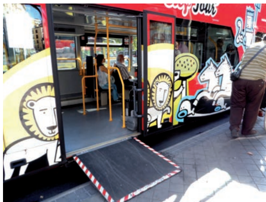
Acceso a autobús turístico de piso bajo mediante rampa.
